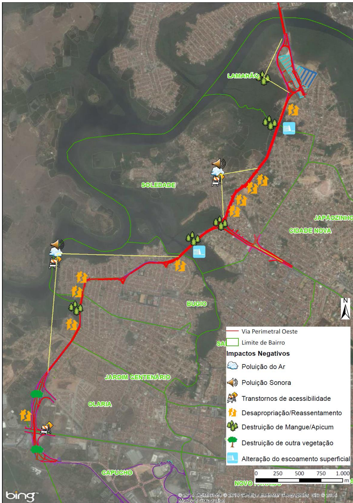
Figura 6.28 – Mapeamento dos impactos da via Perimetral – Trecho 1 (fase de implantação).
